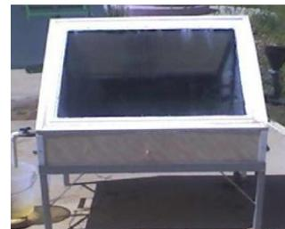
Figure 2 : Distillateur solaire simple pente (Batna)
