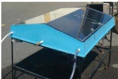
Figure 3 : Distillateur à double pentes (Bou-Ismaïl)
